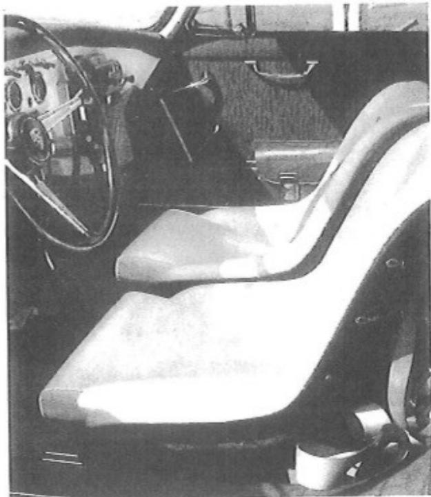
Links: Diese Schalsitze (eine Luxus-Ausführung der Spyder-Schalsitze) machen sich ja wirklich gut und verleihen dem Interieur eine gewisse Grand Prix-Atmosphäre. Unten: Heckpartie mit Rückfahrscheinwerfer auf dem linken Stoßstangenhorn. Das Kennzeichen, speziell beleuchtet, ruht unter der Stoßstange. Über den normalen Blinkleuchten extra große (schwedische) Katzenaugen
