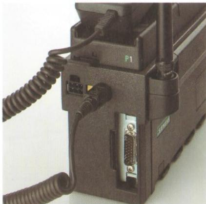
Anschlußseite für Netzteil und Kfz-Einbausatz
