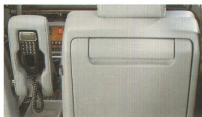
*Integriert in den Klappstisch der Beifahrersitz-Lehne ist der PC. Durch Lösen der Verriegelung kann er direkt mitgenommen werden.*
