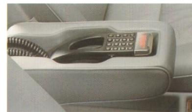
*Das neue Mercedes-Benz Autotelefon (C-Netz) mit integrierter Tastatur im Hörer ist in der Armlehne des Fahrersitzes angebracht (auf Wunsch mit Freisprech-Einrichtung).*
