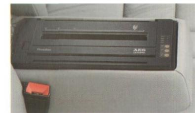
*Multifunktionales Faxgerät (AEG Olympia Roadfax PC): Senden, Empfangen, Kopieren; außerdem dient es als Drucker für den PC und zur PC-Datenübermittlung.*
